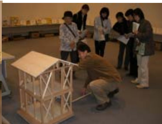
木造家屋の倒壊実験
