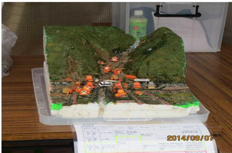
土砂災害模型で土石流発生と被害地区を示す
