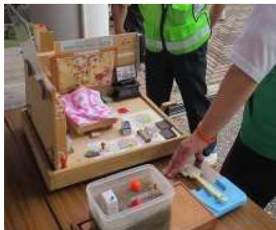
液状化模型実験シミュレーター(手前)
