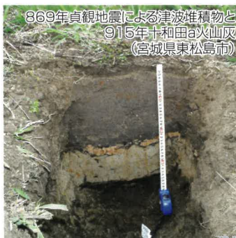
ハンディージオスライサーによる 津波堆積物の調査 (宮城県東松島市)
