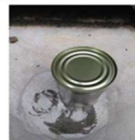
接合部分がとれて中の汁が出てきました。
